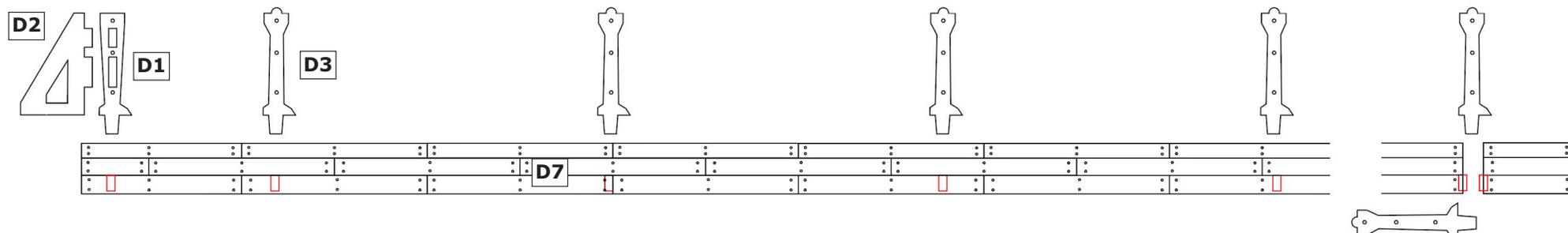
Sur le modèle livré en kit, les rambardes sont constituées de supports bois **D3** à coller dans les logements prévus à cet effet et de profilés laiton de  $\varnothing$  0,4 comme illustré ci-dessous. Le début de la rambarde **D1** comprend un appui de soutien **D2** à coller à chaque extrémité du passage piétonnier des deux côtés.
