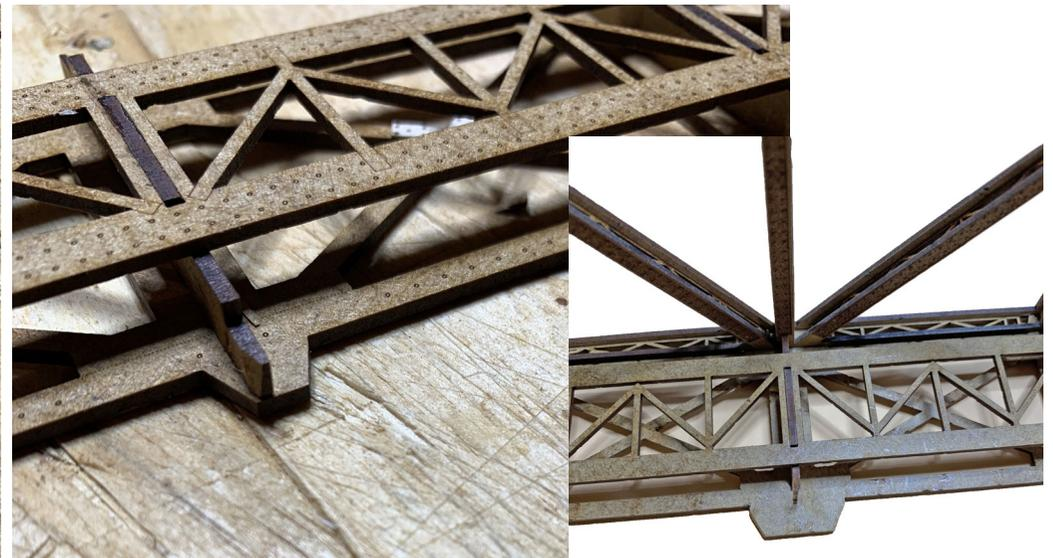
Biseauter les tenons, positionner la travée complète assemblée avant collage avec les latéraux après avoir testé le bon assemblage de ces pièces entre elles.
