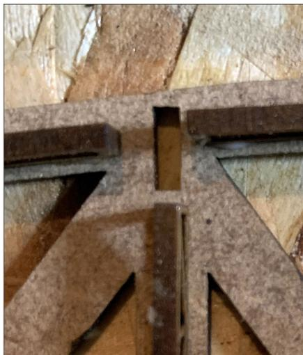
Les entretoises doivent être posées en laissant libre au passage les mortaises de montage supérieures et inférieures.
