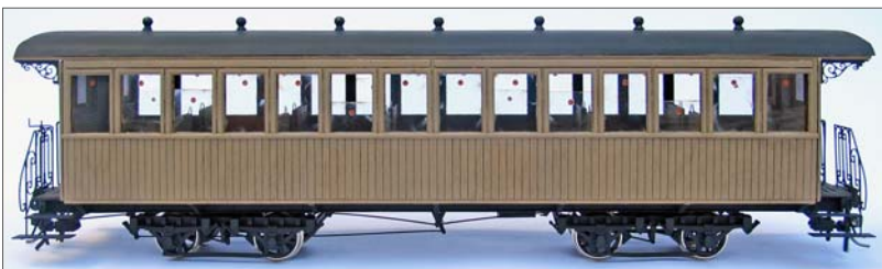
Réalisé en contreplaqué de 0,4, 0,8 et 1,5 mm
